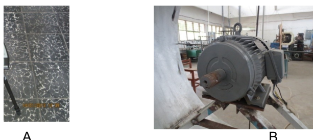
A B Gambar 3. (a) Alat uji kebisingan B&K Type 2238 Mediator; (b) Motor listrik
